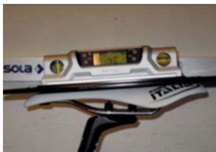
Inclinaison trop importante
